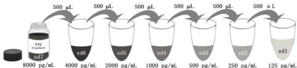
检测细胞裂解液样本，使用1mL PT 5-ef 样本稀释液复溶标准品，具体操作如下：
