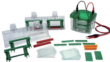
▲ 电泳以Bio-rad微型垂直电泳槽为例
